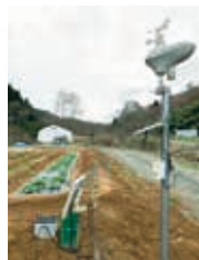
スマート電柵システムの現地試験
