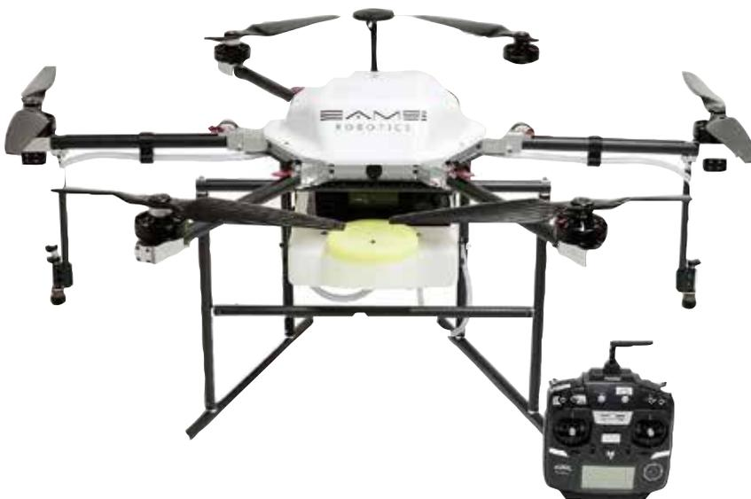
約10分のワンフライトで4.0リットル(0.5ha)の散布が可能です。レーザーレンジファインダー搭載で農地の起伏に合わせて飛行し、操縦を補助します。取替が可能な、粒剤散布装置もあります。
