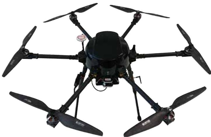
線量計搭載型の放射線測定業務用ドローンです。
