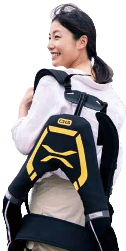
人工筋肉のはたらきで、その人自身の動作を助け、作業負担の軽減に貢献する装着型ロボット。人や重い物を持ち上げたり、中腰姿勢を保ったりする作業を楽しめます。介護施設、工場、物流、建設現場、農作業…さまざまな場面で導入が広がっています。
