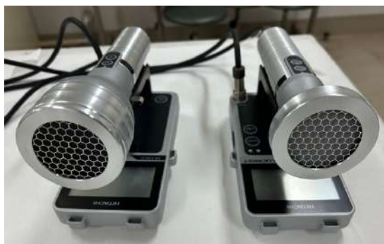
図 1 プラスチックシンチレーションサーベイメータ（右）と GM サーベイメータ（左）
