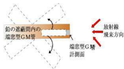
図7 方向を変えた計測方法の概念図
