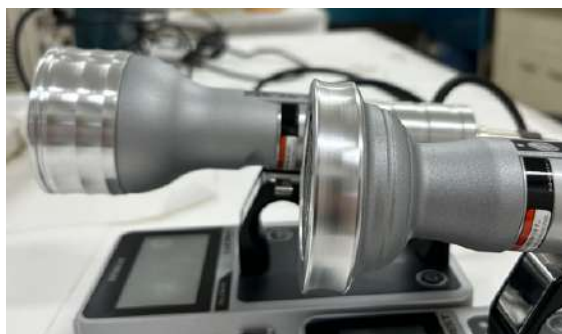
図 2 プラスチックシンチレーションサーベイメータ（右）と GM サーベイメータ（左）の検出部分
