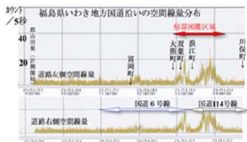
図 1 車両搭載装置による放射線の計測例 (2020)
