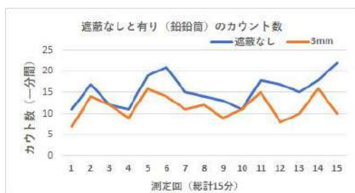
図5 鉛筒カバー（遮蔽体）によるカウント数の低減の例（室内実験）
