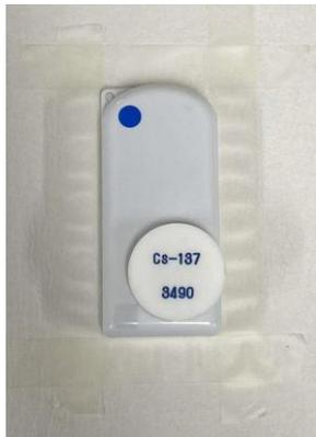
図 5 D-シャトル検出部にCs-137を密着させる様子
