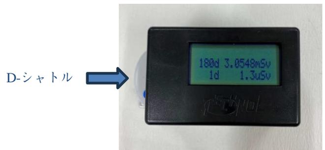
図2 簡易表示器にD-シャトルを差し込んでいる様子
