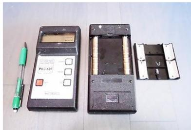
図2 三つの計測モードを有するPKC機
