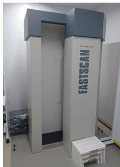
図1 立位型ホールボディカウンタ「FASTSCAN」
