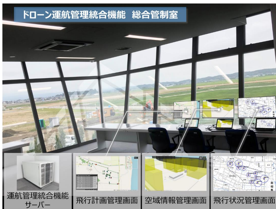
図1 福島ロボットテストフィールドの総合管制室と運航管理統合機能サーバー
