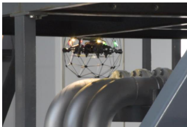
< 図 2-6: パイプの損傷を点検する様子 >
