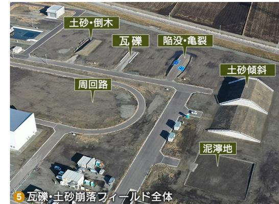
5 瓦礫・土砂崩落フィールド全体
