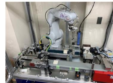
エンジニアがロボットシステムの稼働を学習する『実習キット』。並列するコンベヤ上を流れる2種のワーク（蓋部分と受け部分）を画像認識し、エア吸着ハンドにより作業台にて結合、ハンド部分をネジ締めハンドへ自動で変更したのち、4隅にネジ締めを行う。再度、エア吸着ハンドに自動変更してコンベヤ上へワークを戻し、ワークへの作業完了状態のNG判定を画像識別する。
