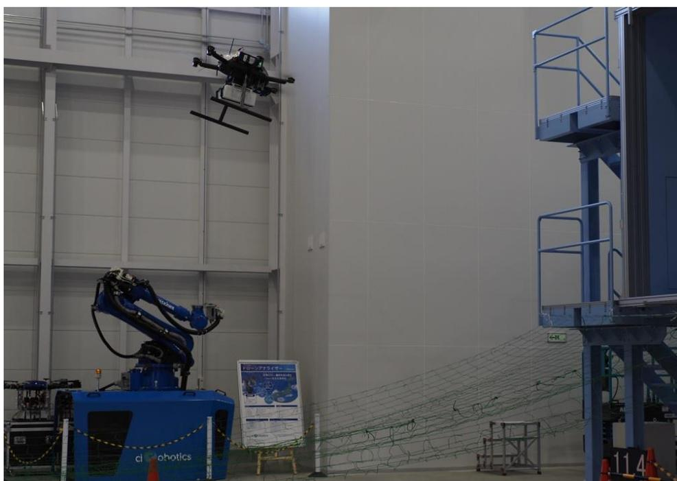
図 2.5-3 飛行試験（小型ペイロード、自動飛行、風速 11.4m/s）
