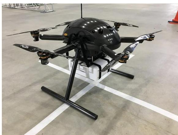
図 2.3-2 小型, ACSL-PF2J(手動)機体
