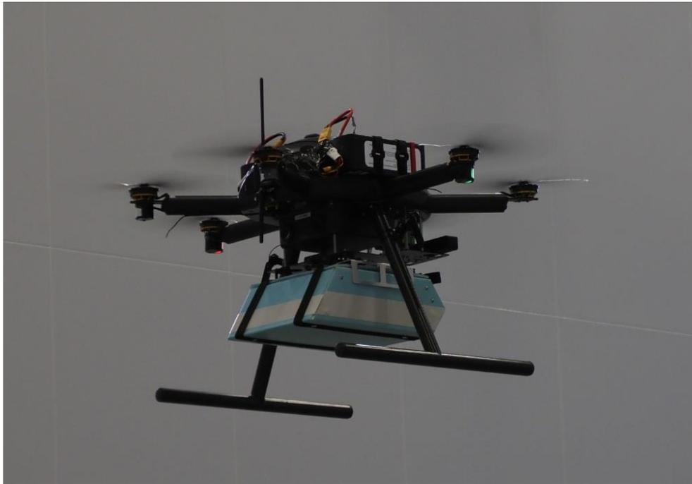
図 2.5-4 飛行試験（中型ペイロード、自動飛行）
