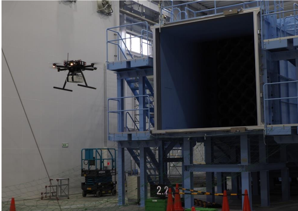
図 2.5-2 試験定位置での飛行 (小型ペイロード、風速 2.2m/s)
