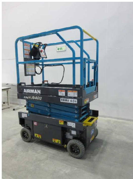
高所作業車（地上高 4 m）
