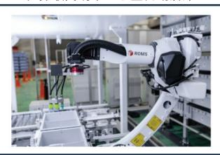
[Robot Picking System(RPS)] 商品を事前登録することなく、 ピック&プレイス可能な弊社が開発した マスターレスのロボットピッキングシステム
