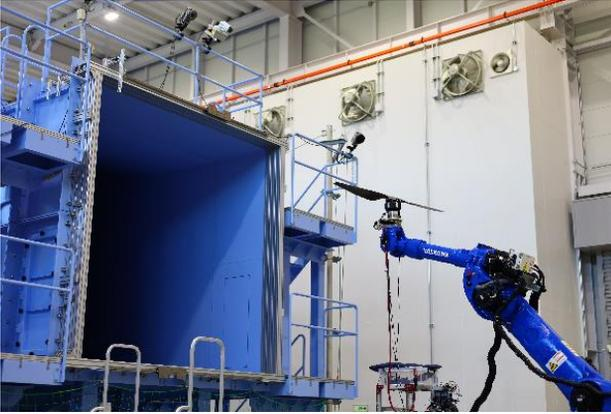
福島ロボットテストフィールド風洞棟内にあるドローンアナライザーを利用し、開発したプロペラの性能試験を実施しています。
