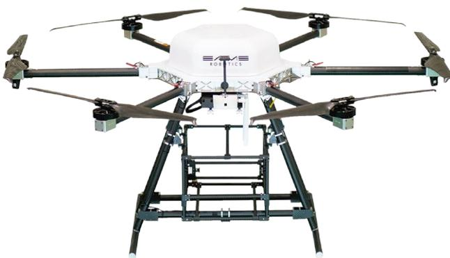
E6150TCは、既存のE6150MPを基に再設計を行った6発の物資輸送用機体です。各地で行われているドローン物流実証試験での利用を想定しています。本機種はカテゴリ-II飛行が可能であり、二等無人航空機操縦士による操縦では一部の特定飛行を除き、従来の許可承認を得ずとも無人地帯での補助者無し目視外飛行「レベル3」までの飛行が可能です。また、飛行リスクに最適化した設計をコンセプトにしており、低価格な第二種型式認証機種の実現を目指しています。
