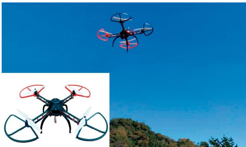
操縦練習用に開発されたドローンです。静寂性を兼ね備え、プロペラガードや脚の部位といった壊れやすい部分は既存品使用で交換も簡単です。有線給電ケーブルを繋ぐことでバッテリー交換がなくなり、残量を気にする事なくスムーズな飛行を続けることができます。
