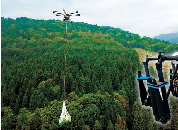
独自のフライトコントローラーにより、吊っている荷が暴れる際に1.5回転内に荷揺れを制御します。また、機体下部のショックアブソーバーにより縦揺れ共振を軽減します。国内初の3オペ操縦切替機能により、遠距離でも確実な作業を実現します。苗木搬送実証実験をはじめ、苗木運搬事業で活用されています。
