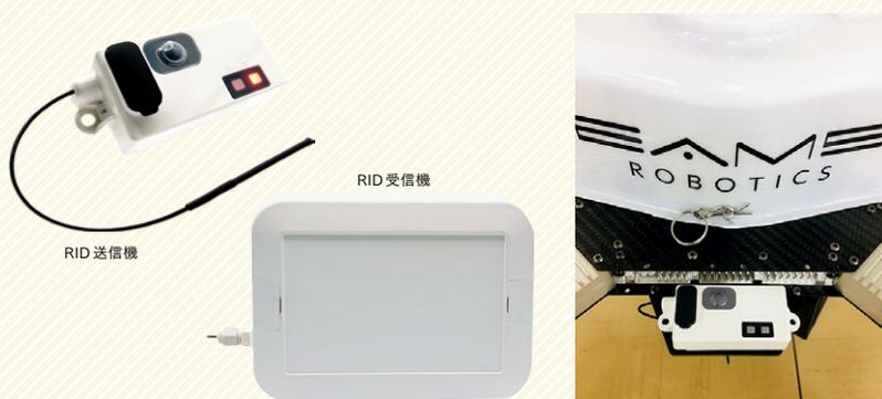
2022 年 6 月 20 日から、ドローンのリモート ID 機能の搭載が義務化されました。EAMS のリモート ID は受信したデータをクラウド上で管理・保存するだけでなく、ドローンを機種ごとに分類し MAP 上にわかりやすくリアルタイム表示し、過去の飛行データから飛行の軌跡を「見える化」。より使いやすく、安全な利用の実現に向けて開発を進めています。
