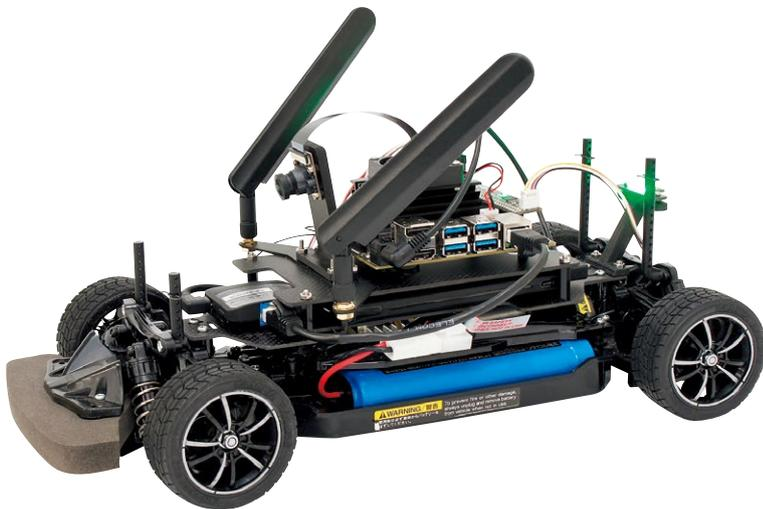
JetRacer(ジェット・レーサー)は、Jetson Nano を搭載した AI ロボットカーのレース車両です。AI カーレース等の競技を通して、Deep Learning を用いたロボット制御を学ぶことが可能です。
