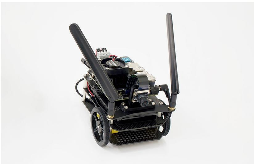
JetBot (ジェット・ボット) は、Jetson Nano を用いた自律型ロボットカーです。Deep Learning のモデルのトレーニングや Deep Learning 推論と連動したロボット制御を、効率的に学習することが可能です。
