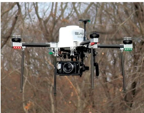
最新のフライトコントローラーPixhawk2と、5GHz帯を使用したハイビジョン映像伝送機能等を搭載しています。標準飛行時間は20分程度で、飛行ログの抜出・解析が可能です。また別の6枚羽機体も含めて、用途・要望に応じカスタム設定も対応しています。
