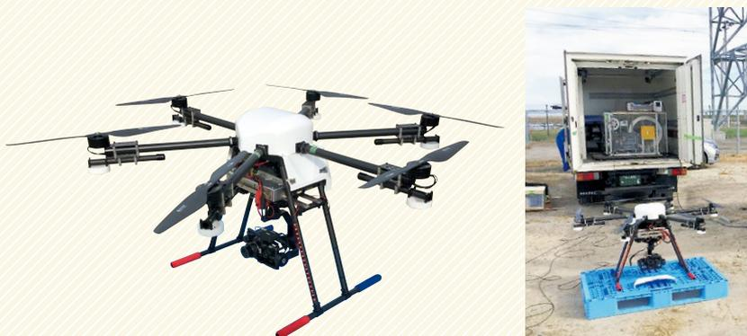
ALSOK 福島では、平成 29・30 年度ロボット関連産業基盤強化事業により、県内で警備・災害監視用ドローンの開発を行いました。有線によりドローンへ電源供給や映像伝送を行うことで飛行時間を大幅に向上させ、広範囲かつ安定・高画質なリアルタイム映像を提供します。特に災害や大規模イベント等の状況把握の際に活躍が期待できます。
