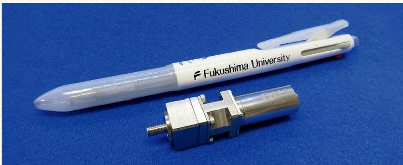
新しい減速機構であるクラウン減速機構を採用し、小型・軽量のボディでも大きな出力トルクを出すことができる減速機ユニットです。クラウン減速機は、小型・軽量のボディでも大きな出力トルクを出すことができます。同時に噛み合う歯数も多く、他の減速機構に比べ、高負荷入力にも耐え、小型化・大減速比に大きく寄与します。同一サイズ比でトルク2倍であり、力が必要なところ、衝撃がかかるところ、装置の小型化にも活用できます。
