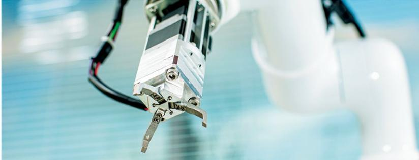
新しい機構である立体カム機構とクラウン減速機を搭載し、小型・軽量のボディでも 20N までの把持力とφ0.5mm のシャープペンシルの芯をつかむなどの精密な動作ができる電動グリッパです。アーム支点より回転開閉できる機構であるため、爪先は開時は本体より大きく、閉時は本体より小さくすることが可能。オリエンタルモーター製 AZ シリーズモーターの制御機能を活用し、爪先開閉範囲の中であれば、把持位置の指令無しで物を把持することも可能です。
