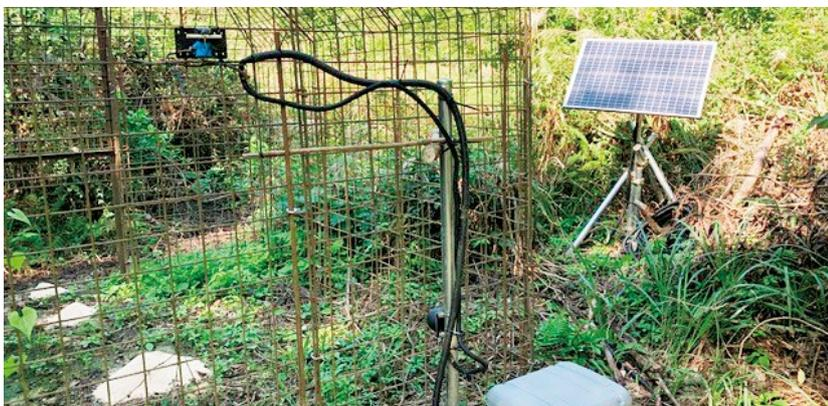
箱わな等に設置することで、A.I. 画像認識システムが獣種を識別し、イノシシやサルなど特定の獣が通った時のみ自動でトリガーを作動させてわな扉を閉め、獣を閉じ込めます。他の動物が檻に入っても扉は落ちません。成獣のみの捕獲や頭数設定も可能です。さらに、トリガーが作動したらメールで通報を行うため、離れた場所から監視することができます。わなを仕掛けるための生態調査や監視のためにも役立ちます。
