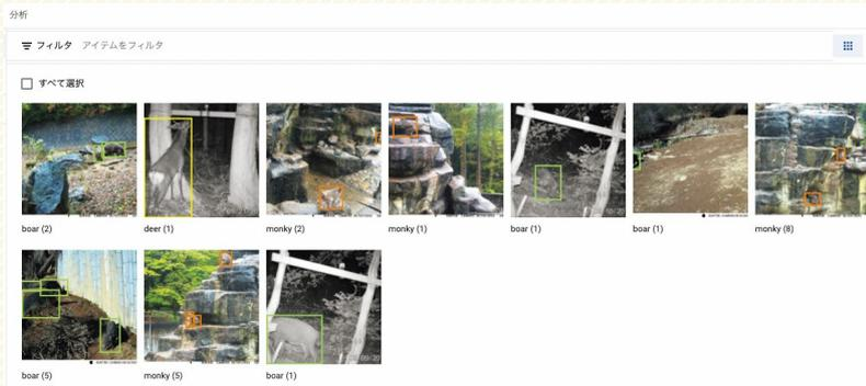
クラウドサーバー上にあるAIがイノシシやサルなどの獣種を特定し、出没情報を自治体等に緊急通報メールを送信するシステムです。通信ユニットを保有するカメラを設置することで、撮影された画像データをクラウドサーバーに送信します。単3電池12本で駆動し電源がないところでも使用できます。暗視機能も搭載で昼夜問わず24時間監視ができます。「令和5年度郡山市チャレンジ新製品認定品」として採択されました。
