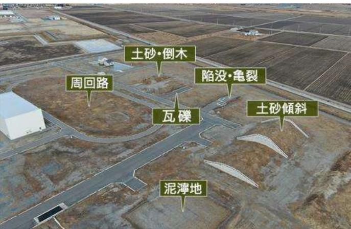
災害時の道路遮断現場、土砂崩落現場を再現し、無人化施工重機やロボットによる状況確認、捜索・救助、復旧作業に関する試験や操縦訓練を行う施設です。道路上に自由に設置できる各種障害物のほか、15度・30度に再現性のある土砂傾斜、軟弱さを調整可能な泥濘地、走行耐久試験用の周回路を備えています。
