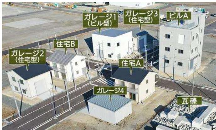
住宅、ビル、信号・標識付の交差点を配置して市街地を再現しています。建物の内外に車両や瓦礫、点検対象物など設置し、情報収集・調査、障害物除去、人員の捜索・救助、点検に関する試験や操縦訓練ができます。コンクリートや木材の瓦礫を使った走行試験、建物の壁・床のブリーチング訓練、道路部分を使った自動走行の試験にも活用可能です。
