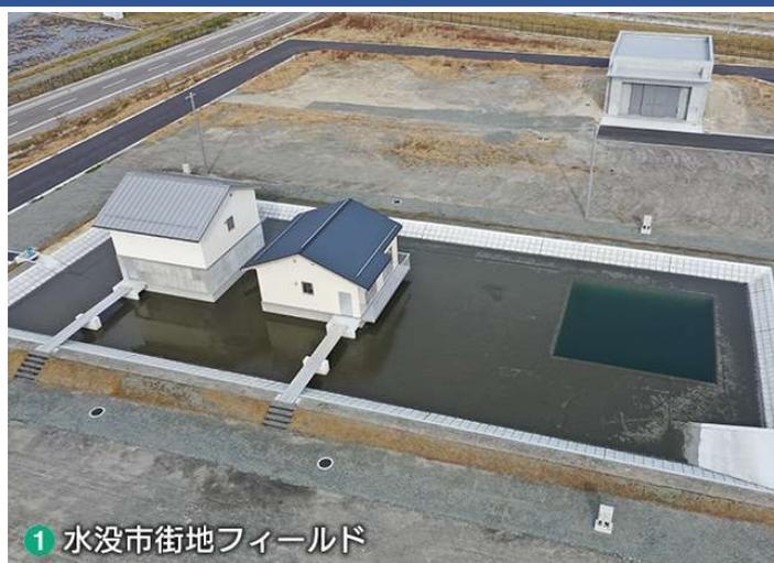
ダム・河川・港湾等を再現し、水中・水上ロボットによる点検・調査に関する試験や操縦訓練を行う施設です。
