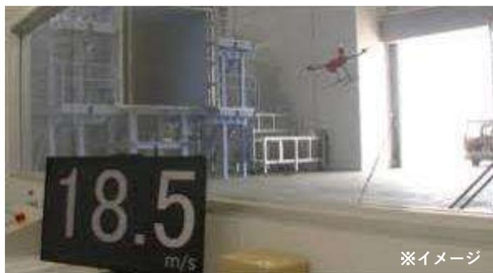
無人航空機の空力特性、飛行性能、積載性能、突風・脈動風への機体の安定性を試験できます。
