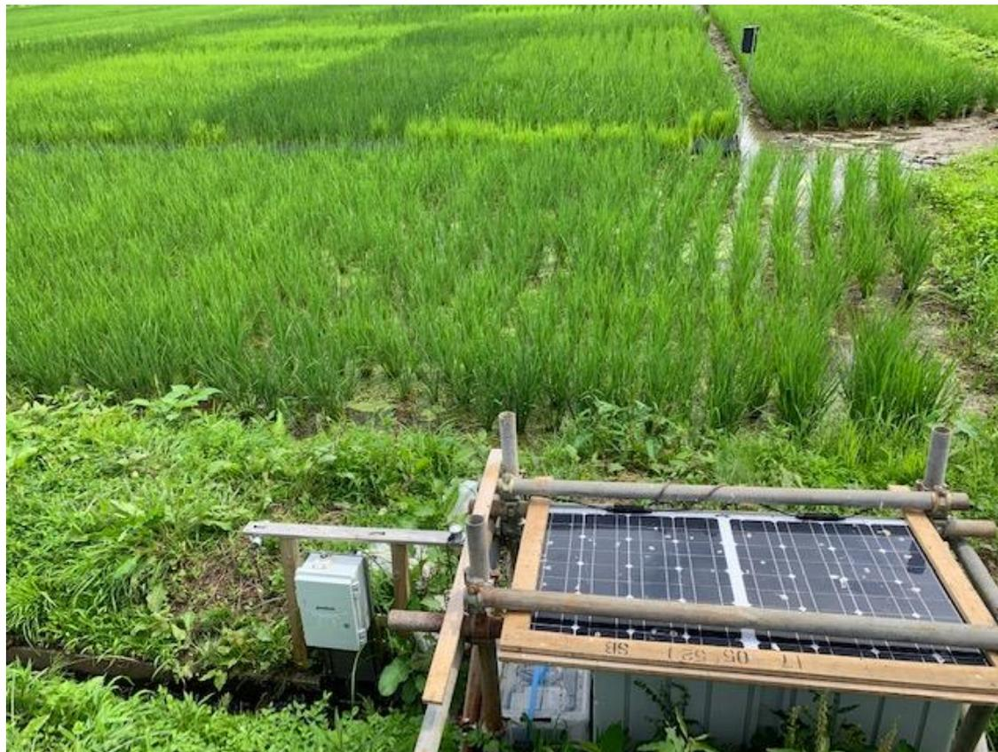
H30年度：IoT, スマホによる自動水門開閉装置、クラウドによる気温、水温、水位データ記録システムを有機栽培水田に導入
