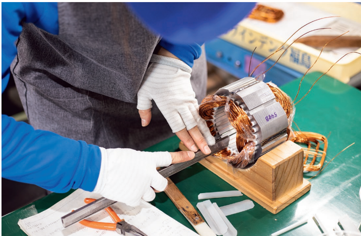
小型インダクションモータのステータ製作
