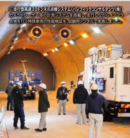
○走行型高速3Dトンネル点検システム(パシフィックコンサルタンツ(株))
