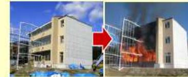
木造3階建て学校の実大火災実験の結果等を踏まえ、建築基準法が改正され、準耐火構造等での3階建て学校の建築が可能に。
