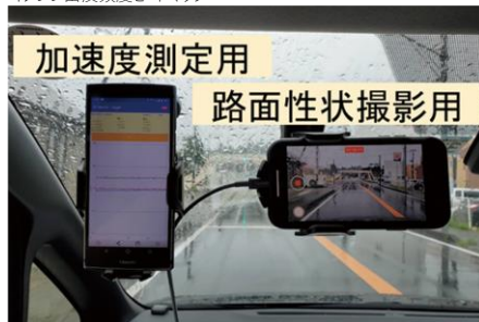
路面変状の点検および路面走行時の加速度計測
