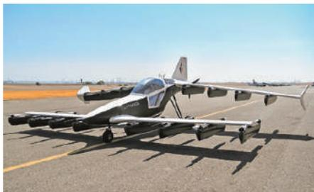
テトラ・アビエーション株式会社は、「移動」をより便利で快適にするための、eVTOLを開発しています。eVTOLとは、ヘリコプターやドローンのように、好きな場所で垂直に離着陸できる、電動の航空機で、今まさに誕生しようとしている新しい乗り物です。福島ロボットテストフィールドを重点的に活用し個人用空飛ぶクルマとしてその技術開発を進めています。
