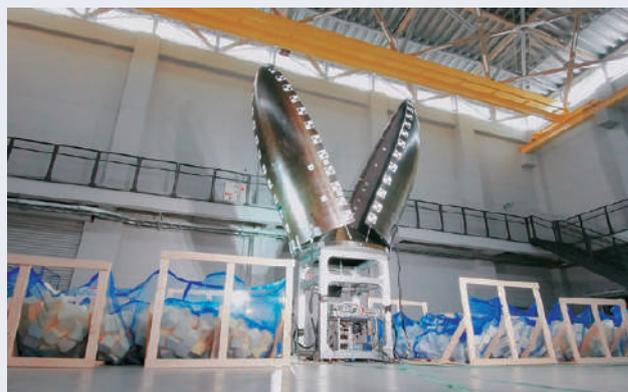
福島ロボットテストフィールドで行われたフェアリングの分離試験
