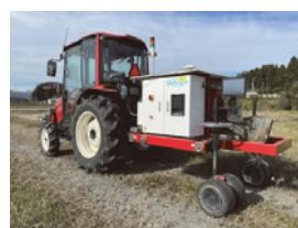
営農再開農地の土壤養分センサーによるモニタリング
