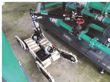
災害対応・インフラ点検ロボットの研究開発・実証
