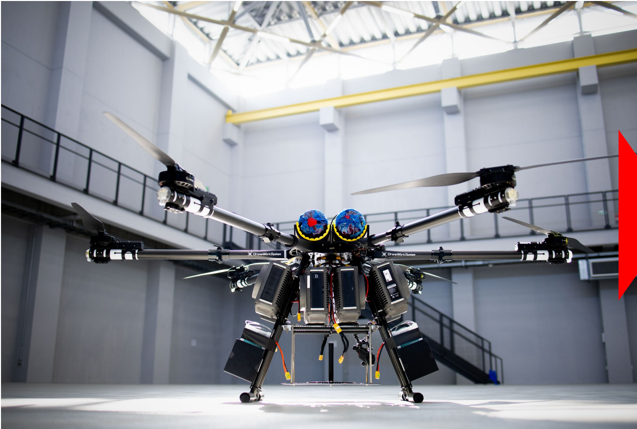
積載量40kgの水素燃料ドローン
