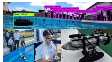
↑ 水上ドローンをFPVで操縦する様子 カメラ映像に対してAI物体検出を実行
