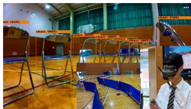
↑ 空中ドローンをFPVで操縦する様子 カメラ映像に対してAI物体検出を実行
