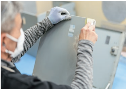
パテ付け作業
