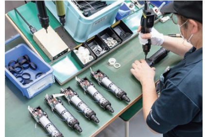
熟練者による電動ドライバ組立
