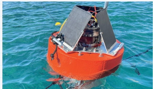
水中センサやカメラをIoT化する、海洋モニタリングシステム「MizLinx Monitor」株式会社MizLinx
