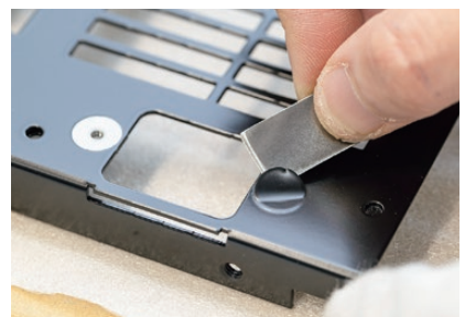
マスキング剥がし作業
