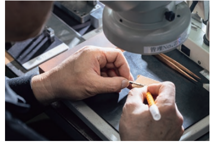
熟練者による手作業でのバリ処理
