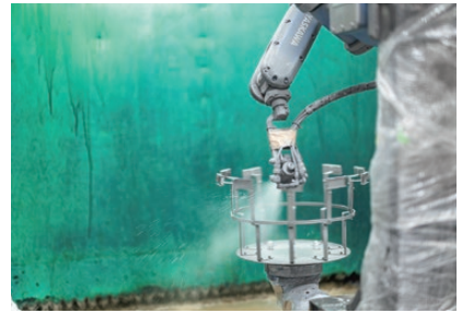
多関節ロボット塗装の様子
