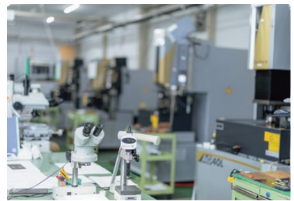
放電加工機 加工精度は±0.002mmを実現
