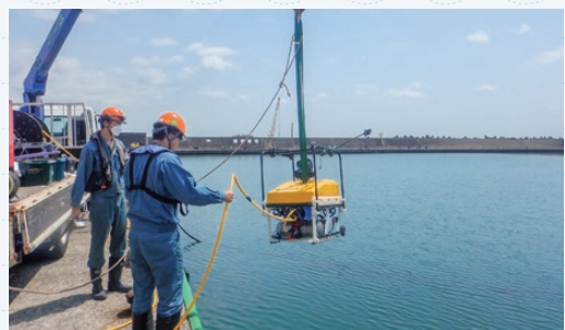
水中3Dスキャナ搭載ROVによる作業状況 株式会社東京久栄
