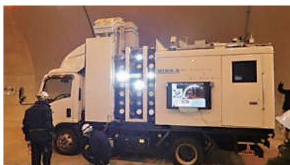
走行型高速3Dトンネル点検システム (MIMM-R)
