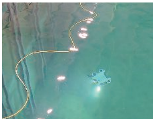
屋内水槽(大水槽)壁面を計測
